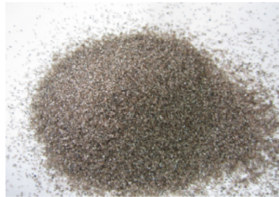
A F36御使用済品の上記工程施行後の再生研削材
